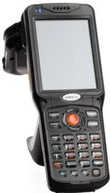
Der neue Topaz-RFID-Handscanner mit SearchLib®-Software kann sowohl das fest angestellte Personal als auch die ehrenamtlichen Mitarbeiter erheblich entlasten. Dieses Gerät ermöglicht eine schnelle Suche nach Büchern und eine mühelose und schnelle Bestandsaufnahme. Verlorene Bücher können mit der Radarfunktion (RFID) leicht gefunden werden. Die Zeitersparnis ist erheblich.
